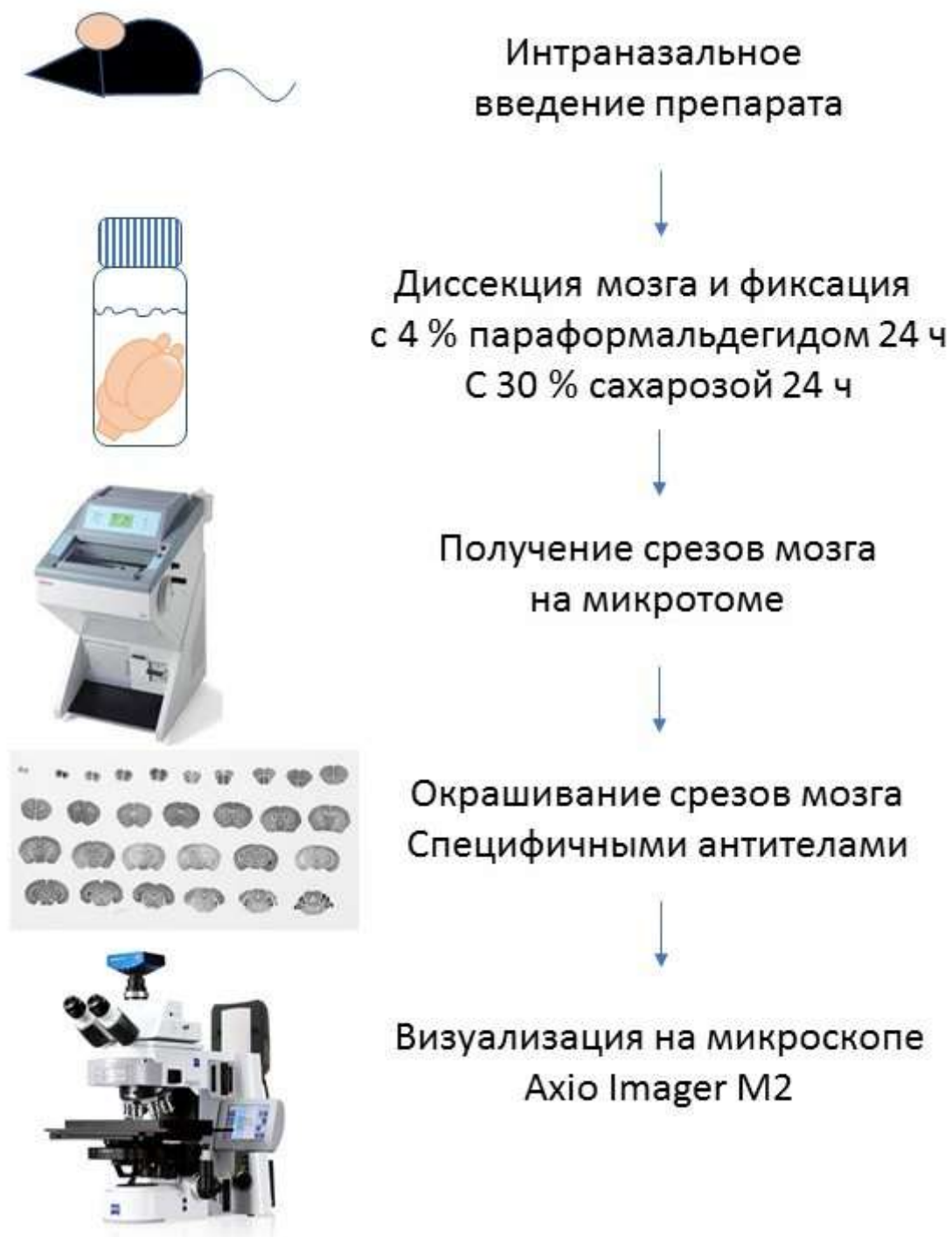
Рисунок 1. Схематическое изображение этапов методики визуализации морфологии мозга с помощью методов иммуногистохимии и флуоресцентной микроскопии.
